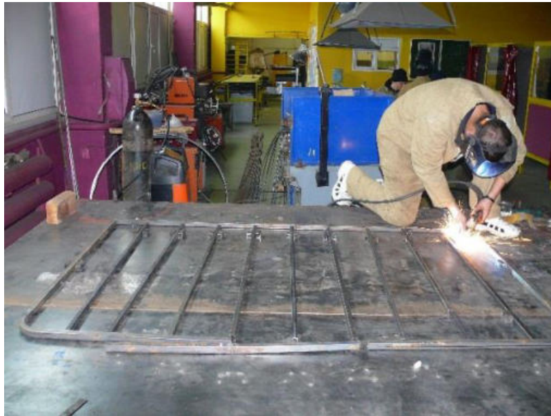
Рисунок 6 - Изготовление шаблона на рабочей поверхности стола
