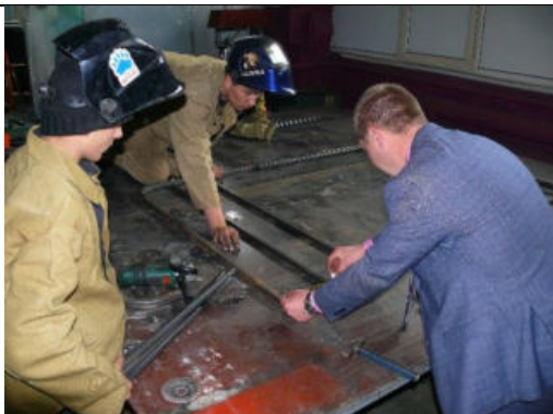
11/ а Сборка ограждения с помощью кондуктора
