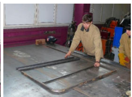
Рисунок 5. - Процесс подгонки расположения каркаса и прутьев без использования
