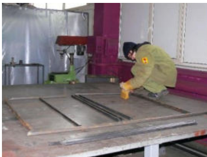
Рисунок 5. - Процесс подгонки расположения каркаса и прутьев без использования
