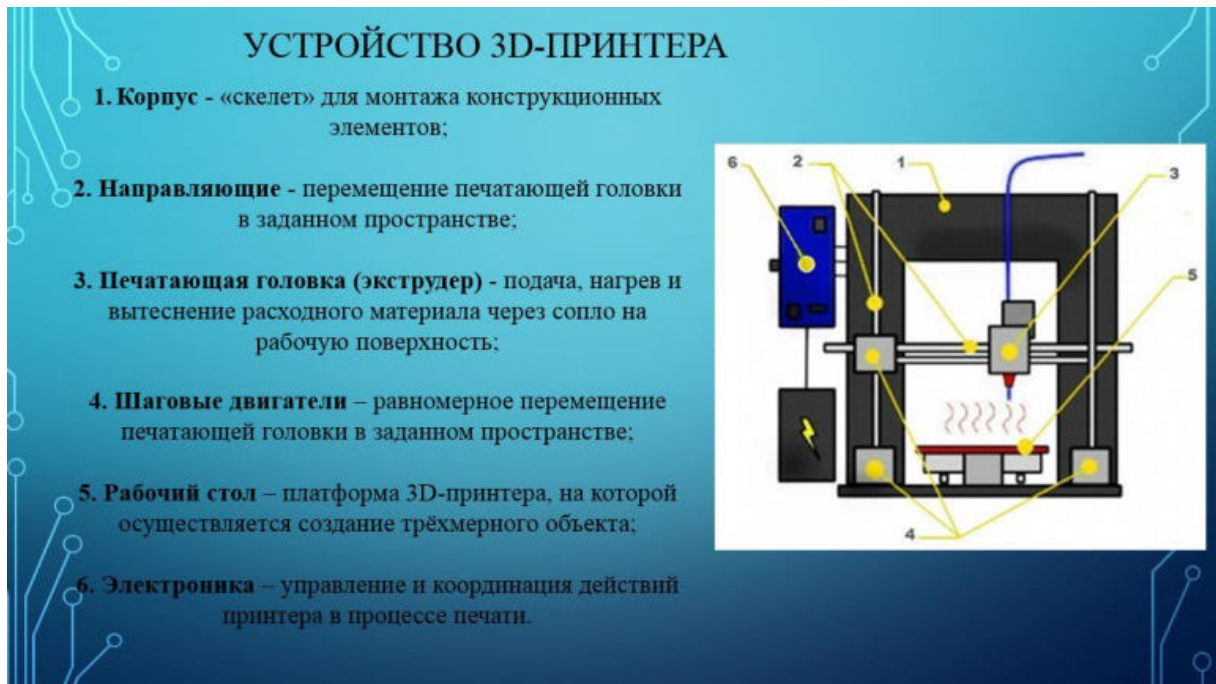
Рисунок 1 – Устройство принтера
