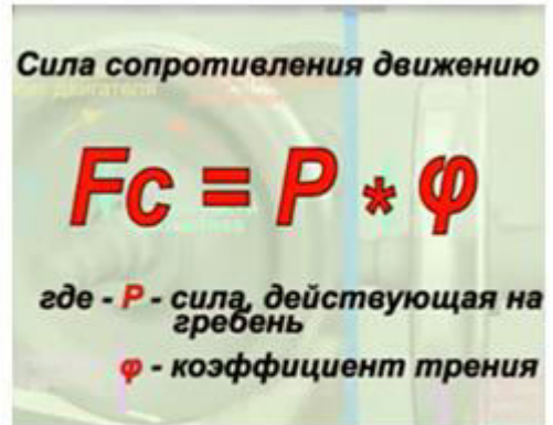
Силы сопротивления действующие на локомотив
