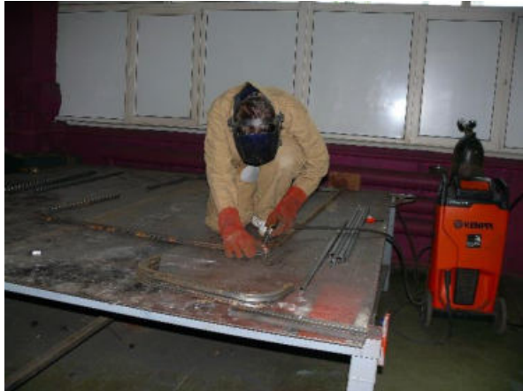
Рисунок 6 - Изготовление шаблона на рабочей поверхности стола
