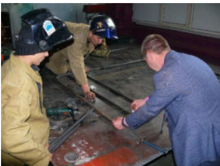
Рисунок 5. - Процесс подгонки расположения каркаса и прутьев без использования
