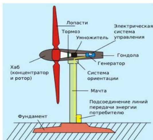
Приложение 1-Схема Ветряной подстанции
