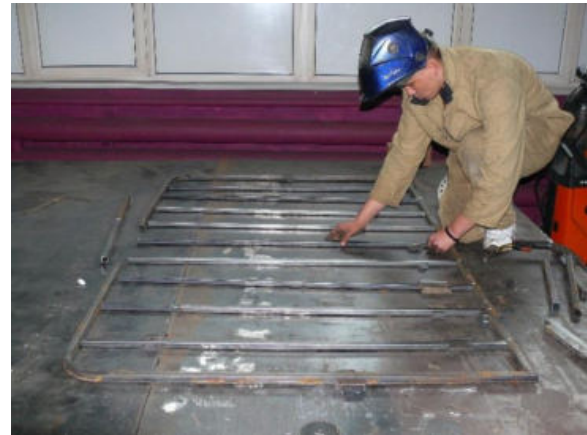
Рисунок 6 - Изготовление шаблона на рабочей поверхности стола
