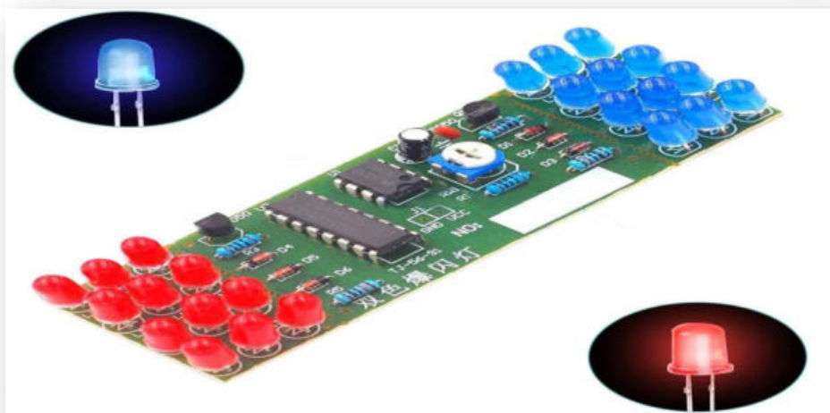
Рисунок 12. Спаянная модель проблескового маячка
